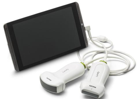
Lumify ermöglicht ultramobilen App-basierten Ultraschall mit dem Android- oder iOS-Smartphone / Tablet.
