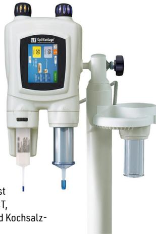
Der OptiVantage von Guerbet ist ein Dualhead-Injektor für die CT, der präzise Kontrastmittel- und Kochsalz-injektionen ermöglicht.
