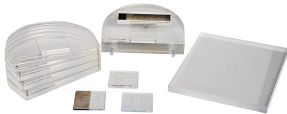
Für Abnahmeprüfung an Mammographie-Einrichtungen gemäß DIN 6868-162
