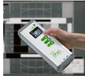
Für Messung der Leuchtdichte an Bildwiedergabesysteme (Graustufen) gemäß DIN 6868-157. Inkl. Maske für Aufsatzmessungen
