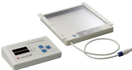
Die Anzeige ergänzt die duo-Messkammer zum kompletten System VacuDAP duo für die Patienten-Dosimetrie. Mit der Anzeigeeinheit lassen sich Einstellungen und Parameter ändern, um die Messkammer an individuelle Messbedingungen anzupassen. Über eine serielle Schnittstelle (RS232) an der Tischanzeige lässt sich ein Drucker ansteuern bzw. die Datenübernahme an ein RIS-System realisieren.
