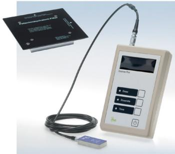
Dosimeter für Konstanzprüfungen. Mit dem passenden Halbleiterdetektor: RQX oder DEDX mit kombinierten Schwächungskörper.
