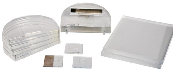
Für Konstanzprüfungen an digitalen Mammographie-Einrichtungen gemäß DIN 6868-14. Bestehend aus:
