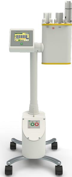
Der Accutron MR3 ist ein Kontrastmittelinjektor, der neben den beiden Kolben für KM und NaCl über einen dritten Kolben speziell für die Infusion von Flüssigkeiten während der Bildgebung verfügt. Diese dedizierte Infusionspumpe ist für die langsame Abgabe zusätzlicher Medikamente vorgesehen, die bei spezifischen MR-Untersuchungen erforderlich sind.
