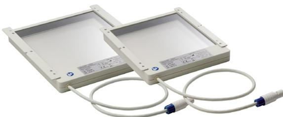
Die Dosis- /Dosisflächenprodukt-Messkammer enthält die komplette Messelektronik und besitzt eine serielle Schnittstelle RS485, über die mit Hilfe eines ASCII-Protokolls die Bedienung der Messkammer und Anzeige der Messergebnisse an der Bedienkonsole des Röntgenerators erfolgt. Zum Anschluss an einen Host Computer steht ein Schnittstellenkabel mit Konverter RS485-RS232 sowie USB und CAN-bus zur Verfügung.
