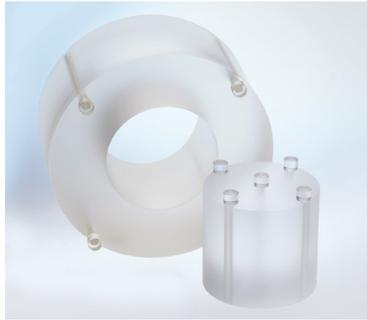
Kopf und Körper (Erwachsene) Phantom für CTDI Messungen gemäß IEC 60601-2-44, IEC 61223-3-5.
